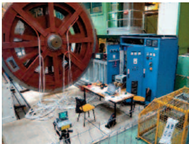
Fig 6. Prototype and converter test lay-out. Fig 6. Configurazione del prototipo ed del convertitore
