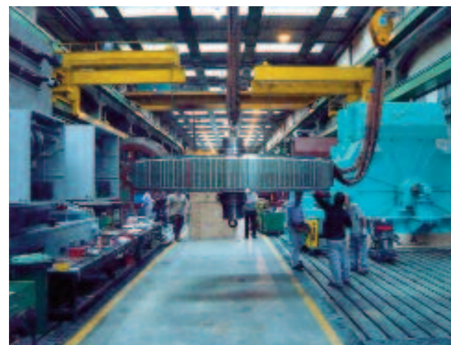
Fig 5. Non-magnetized rotor manipulation in the workbench; it is evident the high polarity in comparison to standard synchronous constructions. Fig 5. Manipolazione sul banco di lavoro del rotore non magnetizzato; è evidente l'alta polarità in confronto alle soluzioni sincrone tradizionali
